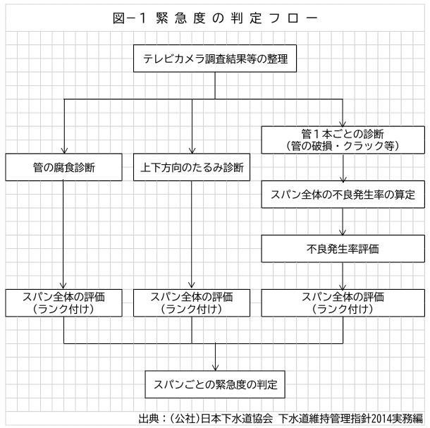
図-1は本管テレビカメラ調査結果から、スパンごとの緊急度を判定する流れを示している。
